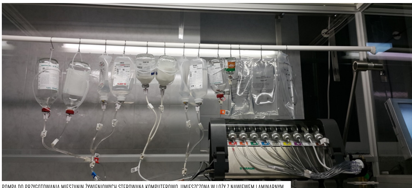
POMPA DO PRZYGOTOWANIA MIESZANIN ŻYWIENIOWYCH STEROWANA KOMPUTEROWO, UMIESZCZONA W ŁOŻY Z NAWIEM LAMINARNYM
